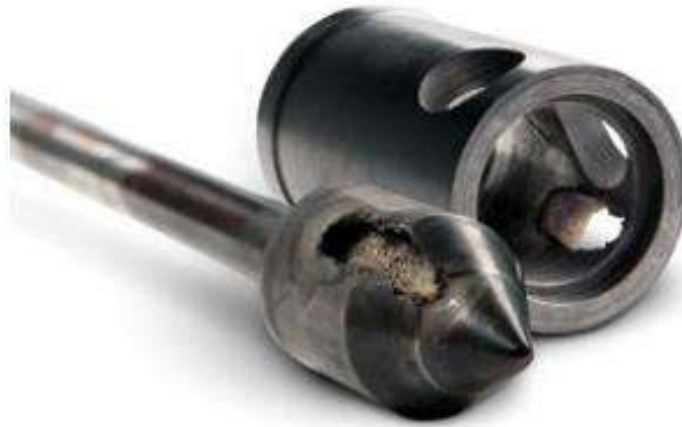
Figura 75. Típica Apariencia Cavitación Fuente: Emersor Fisher (2017)
